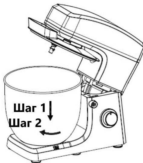
4. Установите необходимую насадку (крюк для теста, лопатку для смешивания или венчик) в шпиндель и поверните против часовой стрелки до фиксации.
