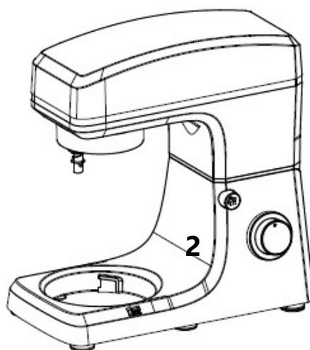
2. Присоедините крышку миксера к моторному отсеку и поверните ее, чтобы она стала на место.
