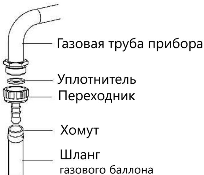
Для подключения к газовому баллону установите хомут на шланг газового баллона. Установите переходник в гибкий шланг газового баллона, предварительно нагрев конец шланга в кипящей воде. Зафиксируйте хомут на конце шланга и закрутите фиксирующий винт хомута при помощи инструмента. Установите прокладку-уплотнитель в переходник (как показано на рисунке) и закрутите гайку переходника на резьбе газовой трубы прибора.
